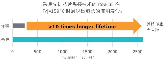
图 16: 标准和先进芯片焊接技术的寿命加速试验结果
